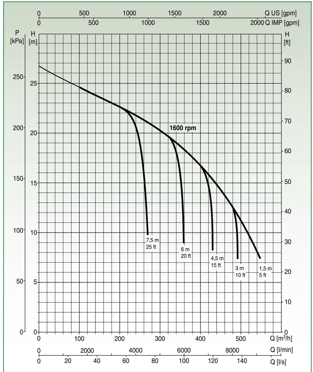
Collaudo a norma UNI EN ISO 9906 livello 2 - Liquido di prova: acqua ( $\rho = 1000 \text{ kg/m}^3$ )
