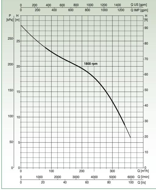
Collaudo a norma UNI EN ISO 9906 livello 2 - Liquido di prova: acqua ( $\rho$  = 1000 kg/m³) Tolleranze sulle curve di prestazione secondo norma UNI EN ISO 9906 Allegato A
