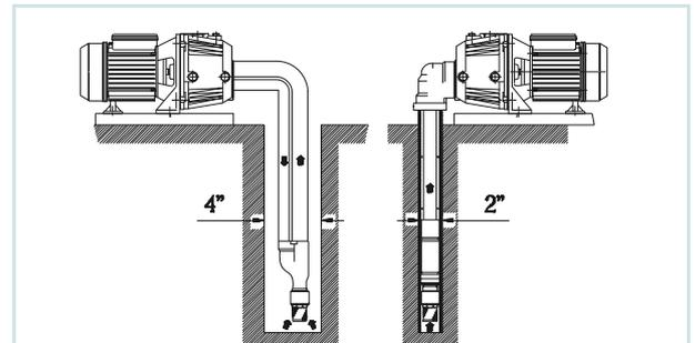
Центробежный насос с выносным эжектором предназначен для подъема воды с глубины более 10 м. Подъем воды осуществляется с помощью двух труб: всасывающей и обратной, на концы которых накручивается эжектор. Диаметр скважины не меньше 4". При установке насоса на скважину 2", необходим специальный эжектор 2" с герметическим затвором на скважине, который монтируется на всасывающую трубу, оставшееся пространство между скважиной и трубой используется как второй рециркуляционный трубопровод.
